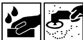
Nach 16 Stunden bei +20 °C können Fehler und Einschlüsse mit Schleifmitteln entfernt und poliert werden:
